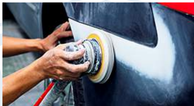
LIXAMENTO DA MASSA COM LIXADEIRA ROTO-ORBITAL
